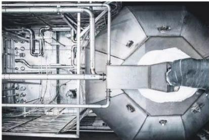
Flüssigsalz, statt Brennstäbe: der erste Prototyp des dänischen Containerreaktors.
